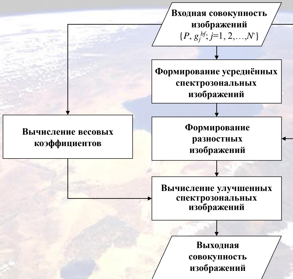
Рис. 7. Структурная схема этапа улучшения пространственного качества
