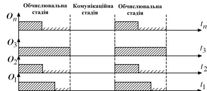
Рис.5.3. Часова діаграма синхронного ітераційного процесу.
