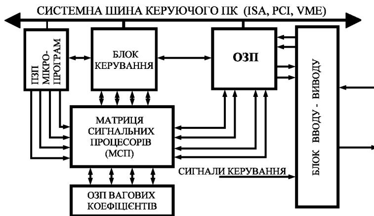
Рис.1.9. Узагальнена функціональна схема нейрообчислювального пристрою.
