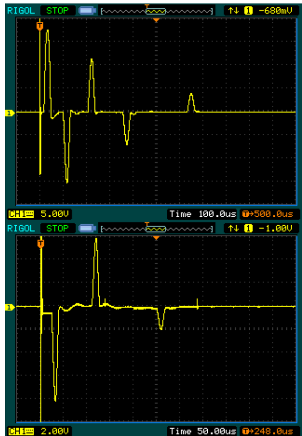
Рис. 5. Осциллограммы тока, протекающего через свечу зажигания, при использовании конденсатора C_2 ёмкостью 2,2 мкФ (слева) и 0,5 мкФ (справа). Шкала по току: слева - 500 А/дел, справа - 200 А/дел
