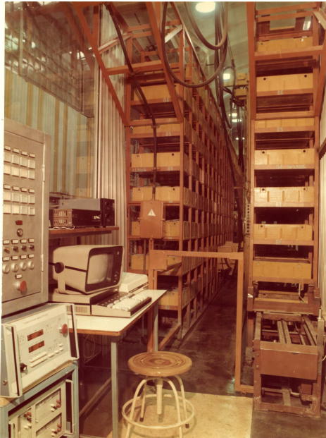
Рис. 7. Автоматизована транспортно-складська система
