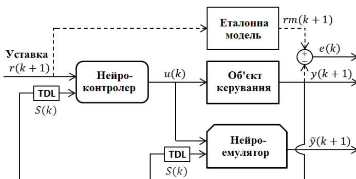
Рис. 1. Структурна схема методу нейроуправління з еталонною моделлю
