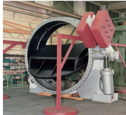
Рис. 9. Заслонки аварийного закрытия ВУГ с управляемым запириением
