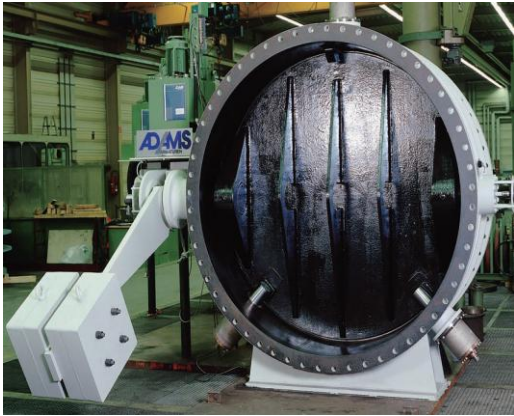
Рис. 9. Заслонки аварийного закрытия ВУГ с управляемым запириением
