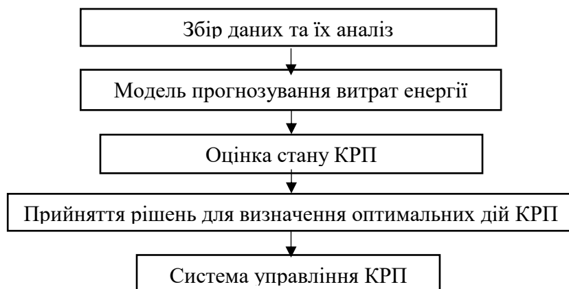
Рисунок 4 – Модель ситуаційного управління з урахуванням заряду акумуляторної батареї
